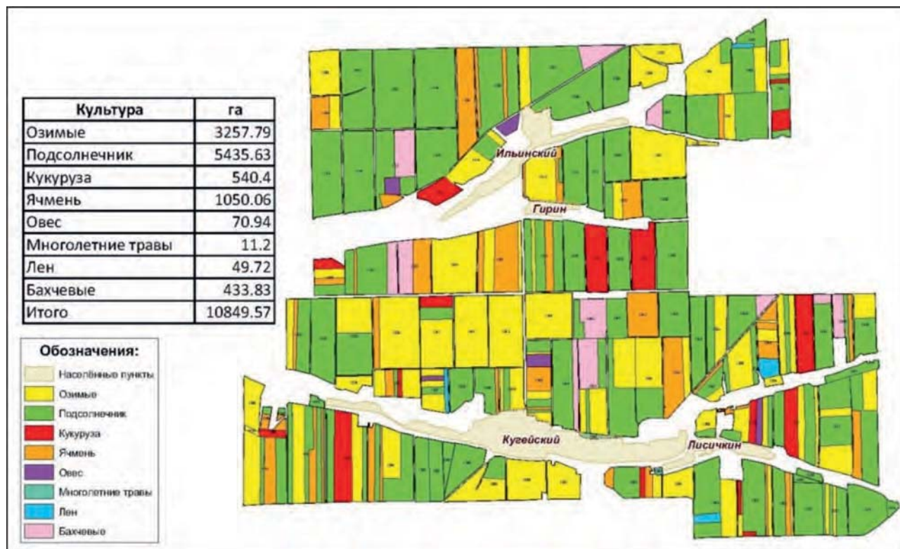
Рис.5.1.5. Структура посевных площадей сельскохозяйственных культур, полученная на основе тематического анализа снимков КА Landsat 7 за 05.06.2016 и 30.06.2016 (Ильинское сельское поселение Егорлыкского района Ростовской области)
